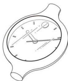
図 1-16 透明材質の物品の表示方法
